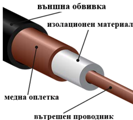
фигура 7 Структура на коаксиален кабел
