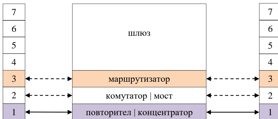
фигура 132. Разположение на устройствата спрямо OSI модела
