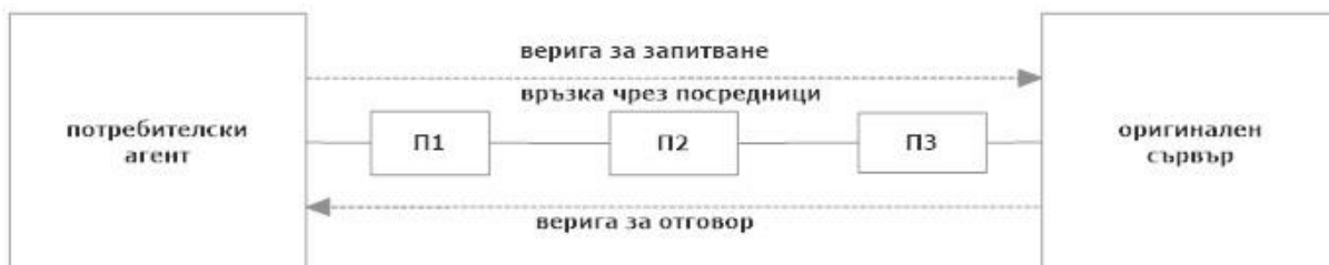
фигура 175 Комуникация чрез посреднически устройства
