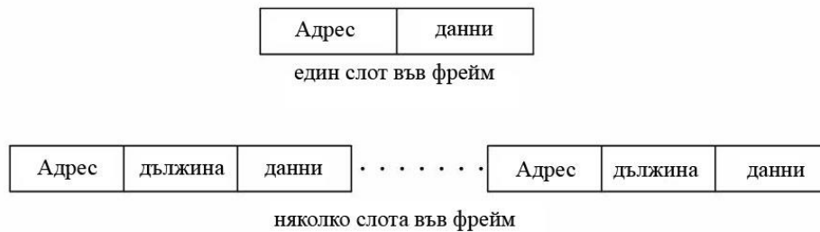
фигура 16 Адресиране на слот при SD
