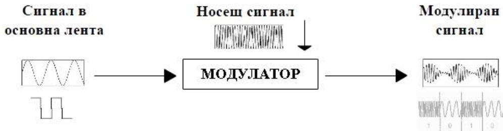
фигура 5 Модулиране на сигнал
